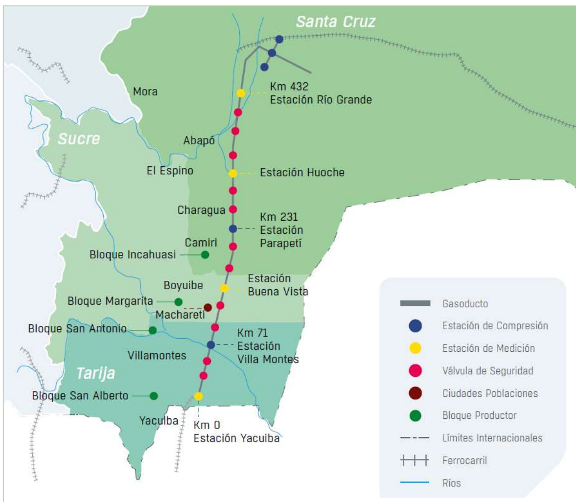
Gasoducto Yacuiba – Río Grande (GASYRG) y sus Estaciones de Compresión y Medición
